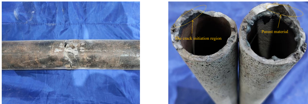
Fig. 11 Fatigue fracture surfaces
