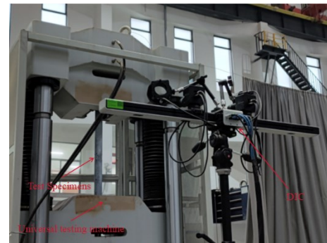
Fig. 5 Tensile test setup
