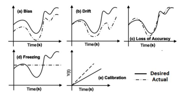
Fig. 2 Common sensor fault type (a) Bias fault;(b) Drift fault; (c) Loss of accuracy fault; (d) freezing fault; (e) Calibration fault
