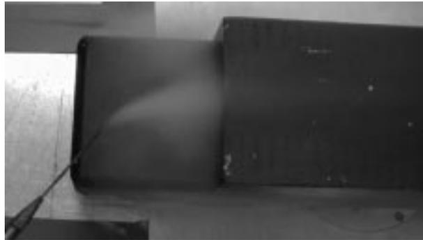
Fig. 6 Flow visualisation using smoke
