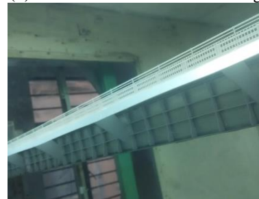
(d) Model added with splitter
