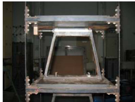
(d) Experimental set-up of SED in second story
