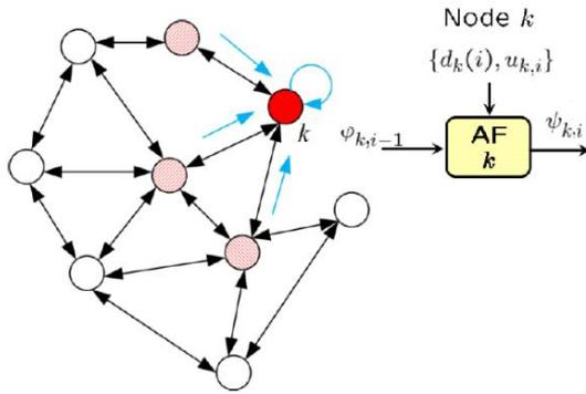
Fig. 2 CTA diffusion algorithm LMS
