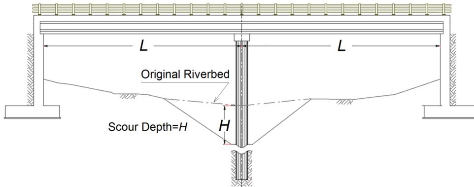
Fig. 11 Definition of parameter H
