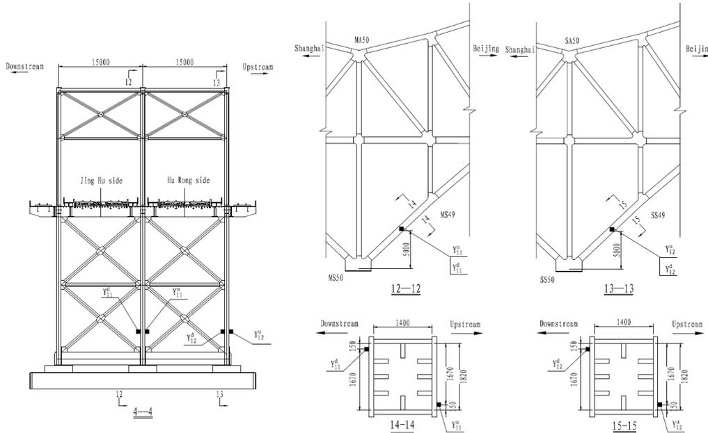
(d) 4-4 cross-section of steel truss arch
