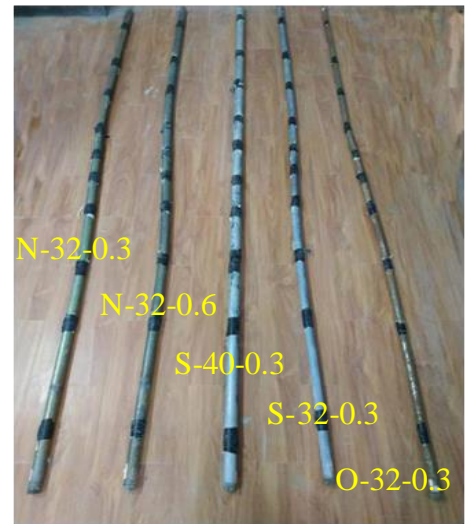
(d) Pipelines deformation
