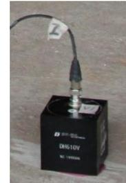
(b) Accelerometer DH610V
