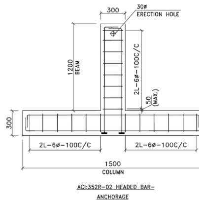
Fig. 4 Specimen type-A
