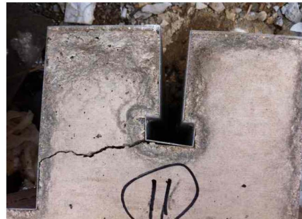
(d) Specimen type B (75-mm embedment)
