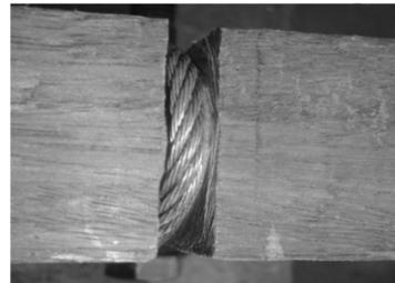
(d) Wire rope inserted in the notch – top view
