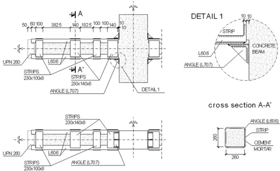
Fig. 5 Specimen AxL.C
