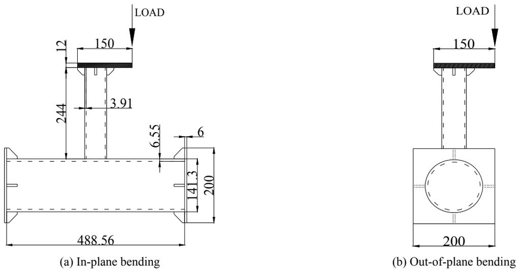
Fig. 13 T-joint configuration
