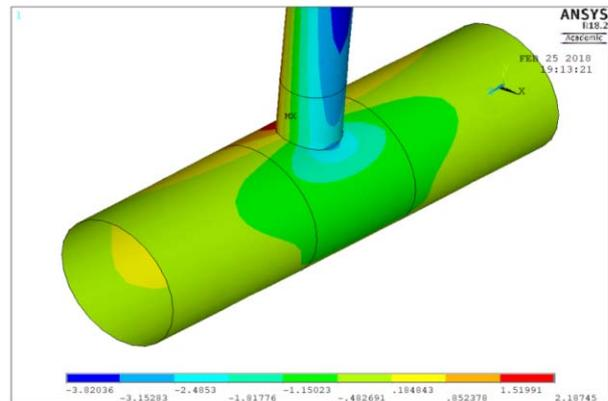
(b) CFRP wrapped T-joint
