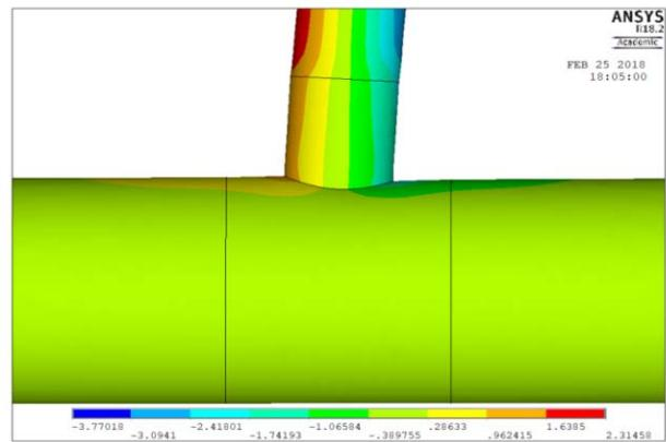
(b) CFRP wrapped T-joint
