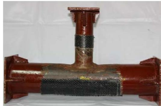
(b) CFRP wrapped T-joint
