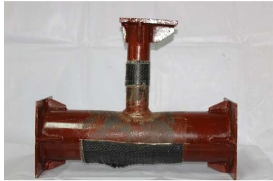
(b) CFRP wrapped T-joint
