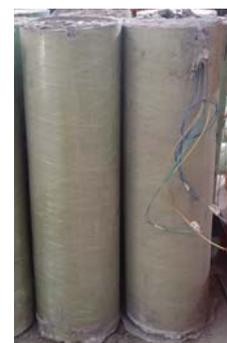
(d) Finished test components
