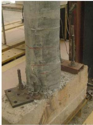
(d) Specimen C4-SR-2CF at failure
