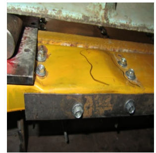
(d) Compression flange failure in Model F
