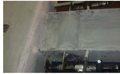
(d) Local buckling at 6% story drift
