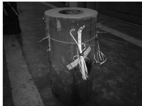
Fig. 1(d) CFDST columns without external steel ring
