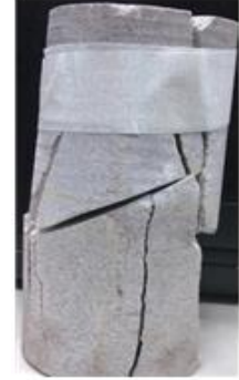
(d) Prefabricated crack of 60° inclination
