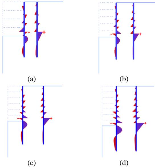
Fig. 10 Shear force diagram (a) Case 1 ( $S_{max}=66.24$  kN/m), (b) Case 2 ( $S_{max}=81.84$  kN/m), (c) Case 3 ( $S_{max}=114.4$  kN/m) and (d) Case 4 ( $S_{max}=144.9$  kN/m)
