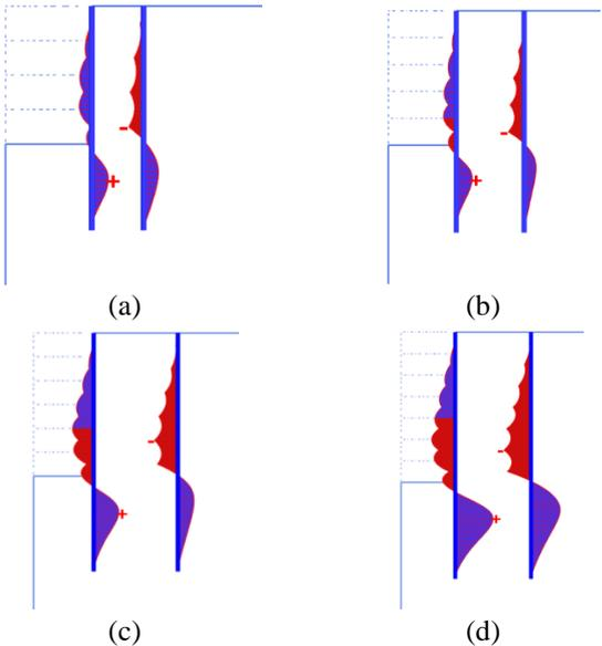
Fig. 11 Bending moment diagram (a) Case 1 ( $M_{max}=48.164$  kNm/m), (b) Case 2 ( $M_{max}=59.47$  kNm/m), (c) Case 3 ( $M_{max}=104.6$  kNm/m) and (d) Case 4 ( $M_{max}=174.8$  kNm/m)
