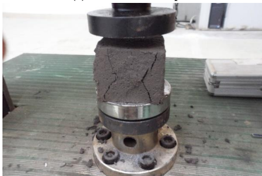
(d) Unconfined compressive strength testing
