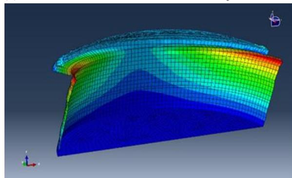
(d) Tank filled to allowable limit –  $f = 0.556$  Hz
