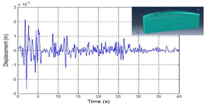
(d) Tank filled to allowable limit (peak value:  $2.70 \cdot 10^{-3}$  m)
