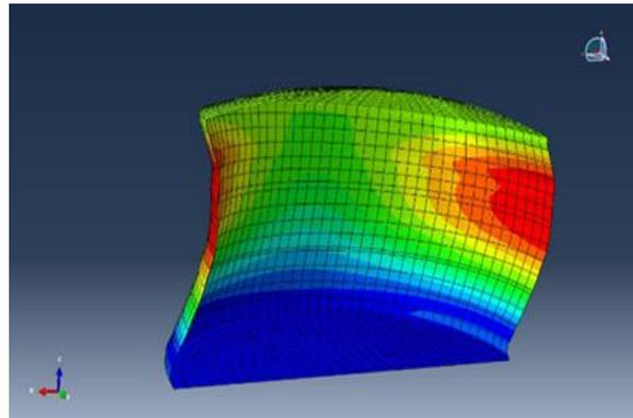
(d) Tank filled to allowable limit –  $f = 0.728$  Hz
