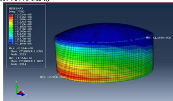
(d) Tank filled to allowable limit –  $t = 2.16$  s (max value: 202.40 MPa)
