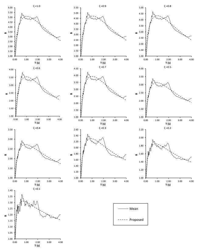
Fig. 3 Reduction factor B diagrams
