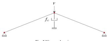
Fig. 5 Viscous damping
