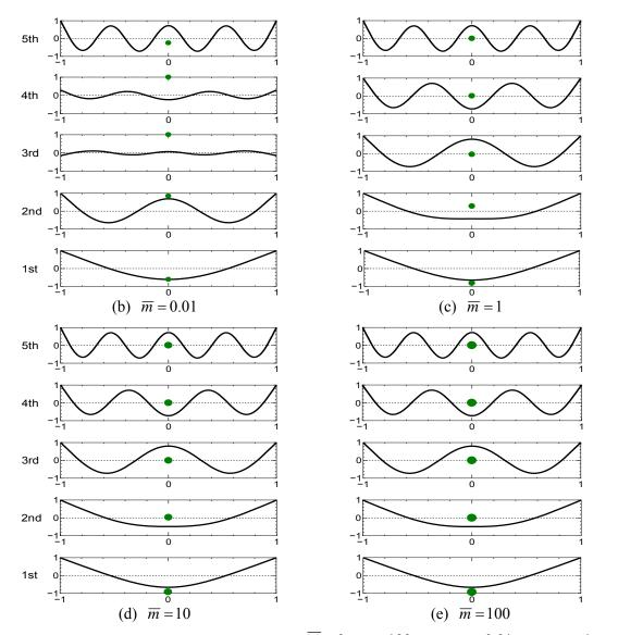
Fig. 10 Coupled vibration modes with  $\overline{m}$ :  $\overline{M} = 0$ ,  $\kappa = 100$ ; (b)  $\overline{m} = 0.01$ ; (c)  $\overline{m} = 1$ ; (d)  $\overline{m} = 10$ ; (e)  $\overline{m} = 100$
