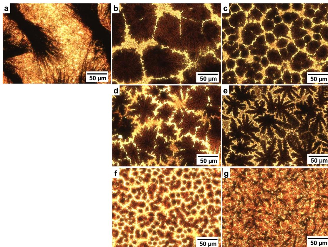
Fig. 5 Optical microscope images of the present devices. (a) Standard  $\text{CH}_3\text{NH}_3\text{PbI}_3$ , (b) SbBr<sub>3</sub> 3 %, (c) SbBr<sub>3</sub> 5 %, (d) SbBr<sub>3</sub> 7 %, (e) SbBr<sub>3</sub> 10 %, (f) SbBr<sub>3</sub> 5 % + CsI 5 % and (g) SbBr<sub>3</sub> 3 % + RbBr 3 %
