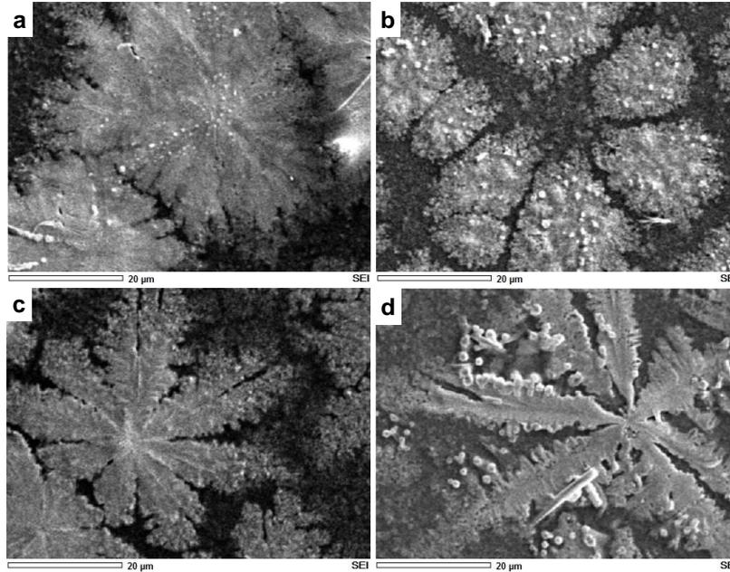
Fig. 6 SEM images of the present devices. (a)  $\text{SbBr}_3$  3 %, (b)  $\text{SbBr}_3$  5 %, (c)  $\text{SbBr}_3$  7 % and (d)  $\text{SbBr}_3$  10 %
